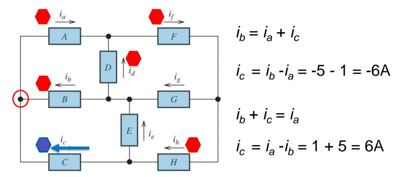
Known parameters:  $i_a = 1A$ ,  $i_b = -5A$ ,  $i_d = 3A$ , and  $i_h = 2A$ ,  $i_f = 4A$ ,  $i_c = -6A$
